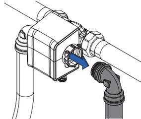
Setzen Sie die Abgangsarmatur für Rohwasser ein und befestigen Sie die Armatur mit den Klammern zwischen dem NeoSoft Anschlussflansch und dem Flexschlauch mit Anschlussbogen.
