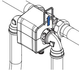
Ziehen Sie den Flexschlauch mit dem Anschlussbogen aus dem Anschlussflansch der CLEAR PRO SOFT TWIN.
