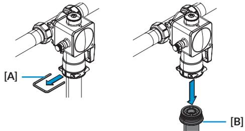
Montieren Sie die Abgangsarmatur **[C]** für Rohwasser von unten an den Anschluss-Flansch und stecken Sie die Klammer **[A]** wieder fest.
