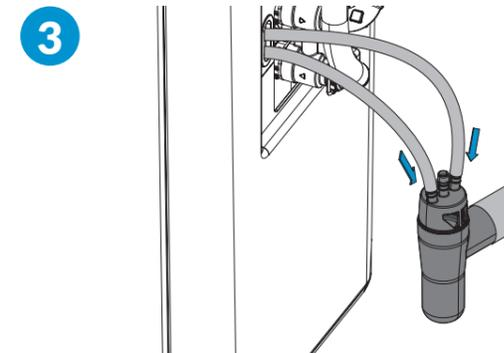
Schließen Sie den Spül- und Überlaufschlauch normgerecht getrennt voneinander an den 3-fach Trichtersiphon (im Lieferumfang enthalten) an.
