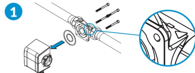
Montieren Sie den Einbauflansch auf den bereits installierten CLEAR Einbauflansch.
