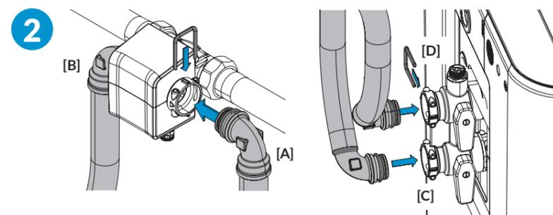
Schließen Sie die beiden Panzerschläuche an den Einbauflansch an (Panzerschlauch Rohwasser [A] am Eingang und Panzerschlauch Weichwasser [B] am Ausgang) und befestigen Sie die Schläuche mit den Klammern.
