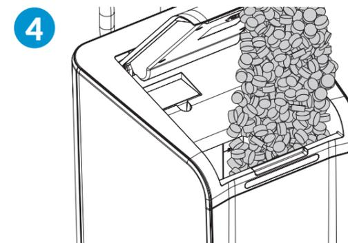
Füllen Sie Regeneriersalztabletten nach DIN EN 973 Typ A in den Salzbehälter.
