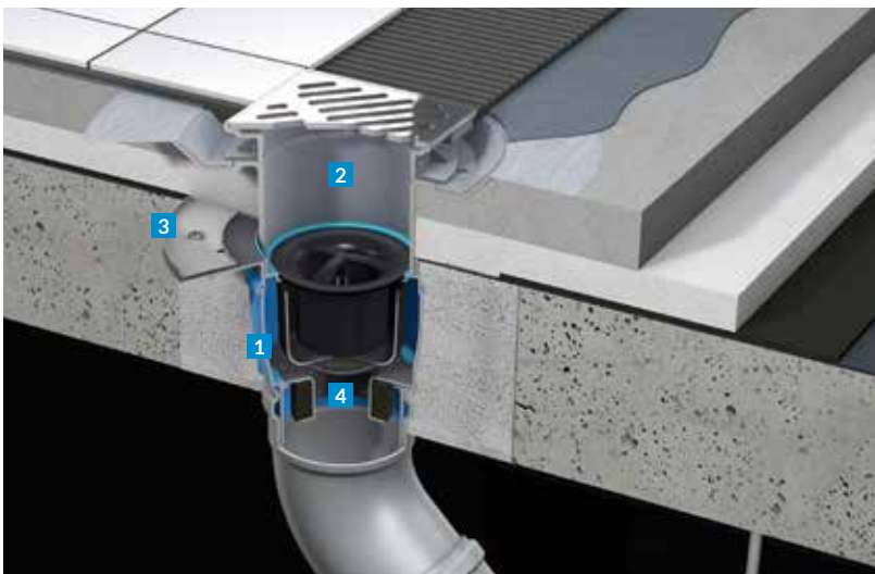
DRAIN Bodenablauf DN 100 mit Brandschutzset und Pressdichtungsflansch sowie Dünnbettaufsatzstück mit seitverstellbarem Rost für konventionelle Abdichtung und Verbundabdichtung
