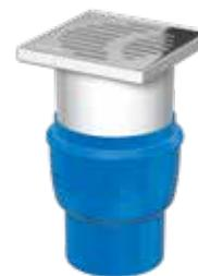
Bodenablauf DN 100 aus Kunststoff, geprüft nach DIN EN 1253-1, mit Halte-/Anschlussrand, mit herausnehmbarem Geruchsverschluss, Sperrwasserhöhe 50 mm, Stutzenneigung 90°, Ablaufleistung 2,0 l/s, Aufsatzstück aus Kunststoff mit Rahmenmaß 150 x 150 mm, mit Edelstahlrost Klasse K 3, mit Bauzeitenschutzdeckel
