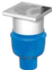
Bodenablauf DN 70 aus Kunststoff, geprüft nach DIN EN 1253-1, mit Halte-/Anschlussrand, mit herausnehmbarem Geruchsverschluss, Sperrwasserhöhe 50 mm, Stutzenneigung 90°, Ablaufleistung 2,0 l/s, Aufsatzstück aus Kunststoff mit Rahmenmaß 150 x 150 mm, mit Edelstahlrost Klasse K 3, mit Bauzeitenschutzdeckel
