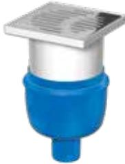
Bodenablauf DN 50 aus Kunststoff, geprüft nach DIN EN 1253-1, mit Halte-/Anschlussrand, mit herausnehmbarem Geruchsverschluss, Sperrwasserhöhe 50 mm, Stutzenneigung 90°, Ablaufleistung 1,6 l/s, Aufsatzstück aus Kunststoff mit Rahmenmaß 150 x 150 mm, mit Edelstahlrost Klasse K 3, mit Bauzeitenschutzdeckel
