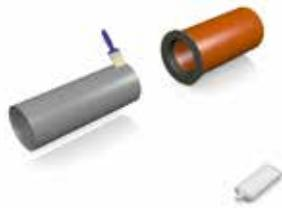
/ Gummiadapter in größeres Rohr schieben. Gleitmittel auf Rohrspitzende auftragen.
