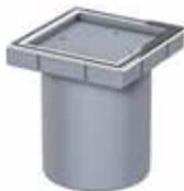
DRAIN Aufsatzstück mit Edelstahlrahmen und befliessbarer Abdeckung 150 mm, Aufsatzstück aus Kunststoff mit Edelstahlrahmen, Rahmenmaß 149 x 149 mm, befliessbare Abdeckung mit Edelstahlrahmen 129 x 129 mm, für Barfußbereich geeignet, Stutzendurchmesser 125 mm, Höhenverstellbarkeit 26 – 135 mm bei Kombination mit Abläufen aus Kunststoff
