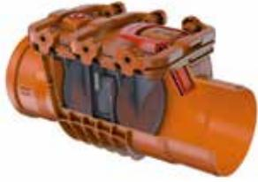
für fäkalienfreies Abwasser, aus Kunststoff. Zwei selbsttätig schließende Klappen, eine davon als handverriegelbarer Notverschluss. Rückstauverschluss: Norm: DIN EN 13564 Typ 2, Einbaukörper: orange, mit drei Schnellverschlüssen für Deckelverriegelung, Nennweite DN 150 (DN/OD 160 mm), Einbauart: frei liegende Abwasserleitung
