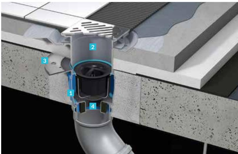
**DRAIN** Bodenablauf DN 100 mit Brandschutzset und Pressdichtungsflansch sowie Dünnbettaufsatzstück mit seitenerstellbarem Rost für konventionelle Abdichtung und Verbundabdichtung
