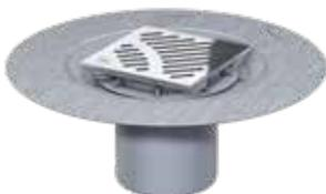
für DRAIN Bodenabläufe DN 50, DN 70, DN 100. Aufsatzstück aus Kunststoff, Edelstahlrahmen, Rahmenmaß 149 x 149 mm, für alternative Abdichtung im Dünnbettverfahren, lose eingelegtes Vlies für die Dünnbettanbindung, Schlitzrost aus Edelstahl (verriegelbar, 140 x 140 mm), Belastungsklasse K 3, für Barfußbereich geeignet, Stutzendurchmesser 125 mm, Höhenverstellbarkeit 36 – 135 mm bei Kombination mit Ablaufkörpern aus Kunststoff
