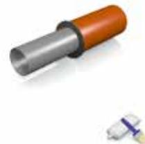
/ Kleineres Rohr in den Gummiadapter schieben.
