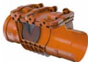
für Regenwasser, aus Kunststoff. Klappe selbsttätig schließend. Einfachrückstau: Norm: DIN EN 13564 Typ 0, Einbaukörper: orange mit drei Schnellverschlüssen für Deckelverriegelung, Nennweite DN 150 (DN/OD 160 mm), Einbauart: frei liegende Abwasserleitung
