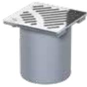
für DRAIN Bodenabläufe DN 50, DN 70, DN 100. Aufsatzstück aus Kunststoff mit Edelstahlrahmen, Rahmenmaß 149 x 149 mm, Schlitzrost aus Edelstahl (verriegelbar, 140 x 140 mm), Belastungsklasse K 3, für Barfußbereich geeignet, Stutzendurchmesser 125 mm, Höhenverstellbarkeit 18 – 135 mm bei Kombination mit Ablaufkörpern aus Kunststoff
