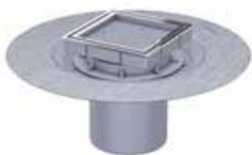
für DRAIN Bodenabläufe DN 50, DN 70, DN 100 mit Edelstahlrahmen, für Abläufe, befliessbare Abdeckung, aus Kunststoff Edelstahlrahmen: 149 x 149 mm, Abdeckung: 129 x 129 mm, für Barfußbereich geeignet, Höhenverstellbarkeit: 36 – 135 mm bei Kombination mit Abläufen, Stutzendurchmesser: 125 mm
