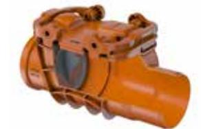
für Regenwasser, aus Kunststoff. Klappe selbsttätig schließend. Einfachrückstau: Norm: DIN EN 13564 Typ 0, Einbaukörper: orange, mit zwei Schnellverschlüssen für Deckelverriegelung, Nennweite DN 100 (DN/OD 110 mm) Einbauart: frei liegende Abwasserleitung
