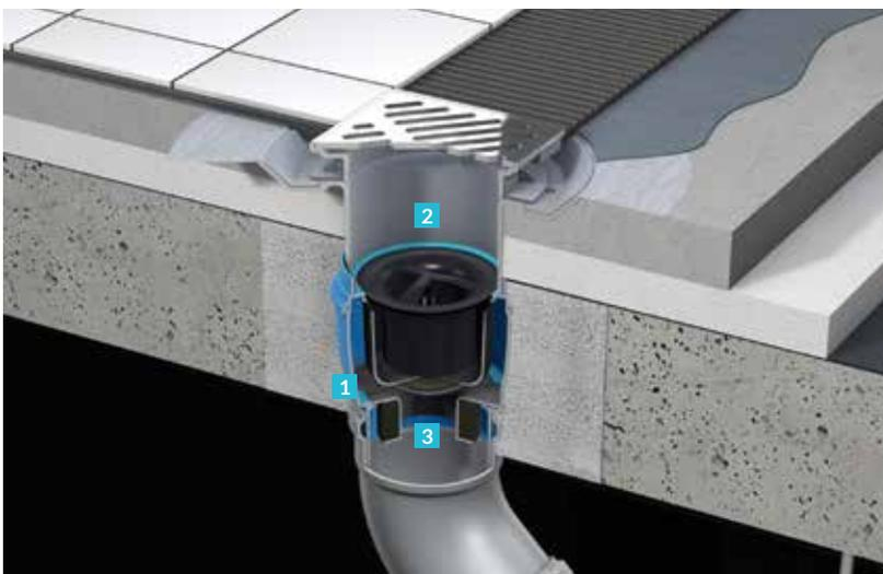
**DRAIN** Bodenablauf DN 100 mit Brandschutzset und Dünnbettaufsatzstück mit seitenverstellbarem Rost für Verbundabdichtung
