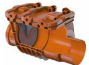
für Regenwasser, aus Kunststoff. Klappe selbsttätig schließend. Einfachrückstau: Norm: DIN EN 13564 Typ 0, Einbaukörper: orange mit drei Schnellverschlüssen für Deckelverriegelung, Nennweite DN 125 (DN/OD 125 mm), Einbauart: frei liegende Abwasserleitung
