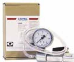
Mt Manometer (0–6 bar) für die Druckprüfung der Gasvorlage, Absperrventil zum kontrollierten Befüllen, Gewinde zum sicheren Aufschrauben auf Gefäßfüller CAREGF, Anklemmventil für das Gasfüllventil aller handelsüblichen Membranausdehnungsgefäße.
