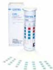
Zur Wasserhärtebestimmung, Anzeige durch Farbumschlag. Handhabung: in die zu messende Flüssigkeit eintauchen, den Härtegrad an der Farbskala ablesen. Kunststoffbox.
