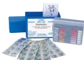
Zur sicheren Bestimmung des pH- und Sauerstoffwertes im Schwimmbadwasser.
