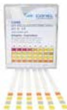
Sofortanzeige des pH-Wertes von wässrigen Flüssigkeiten durch Farbanzeige. Ermittlung durch Eintauchen in die zu messende Flüssigkeit. Ablesung an der pH-Farbskala. Aufbewahrung in einer praktischen Kunststoffbox.
