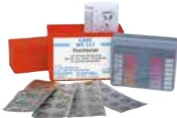
Zur sicheren Bestimmung des pH-Werts und freien Chlorwertes im Schwimmbadwasser.
